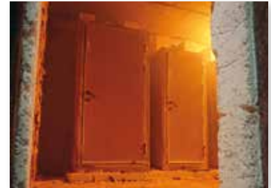
Brandkammer mit funktionsfähigen Einbauten nach 90 minütiger Beflammung.
