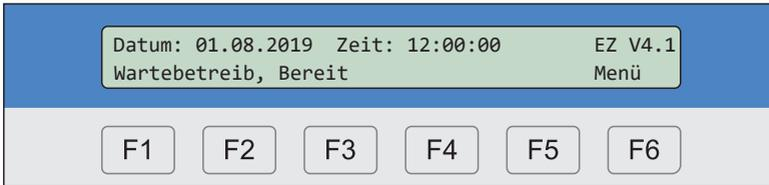
In der Statusanzeige können spezielle Funktionen für die Inbetriebnahme und Fehlersuche über Kurzbefehle aufgerufen werden. Drücken Sie zum Auswählen der gewünschten **Kurzbefehle** die nachfolgend genannten Ziffernblöcke und **bestätigen Sie jeweils mit F2**.
